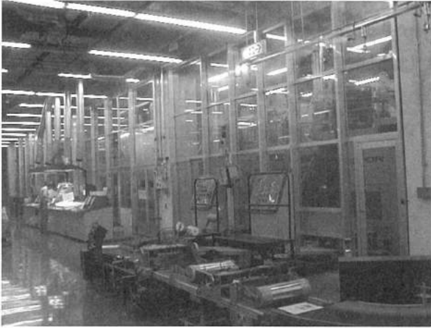
② 輪転機の効率化、パーテーションで囲って騒音も低減
