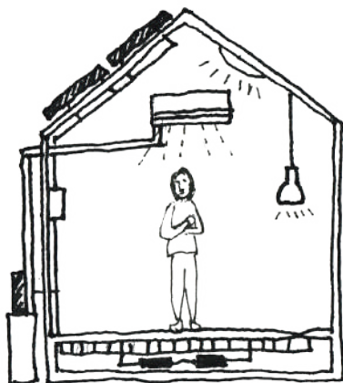
断熱性能が低くエネルギー消費が多い住宅 (使用するエネルギーも多い)
