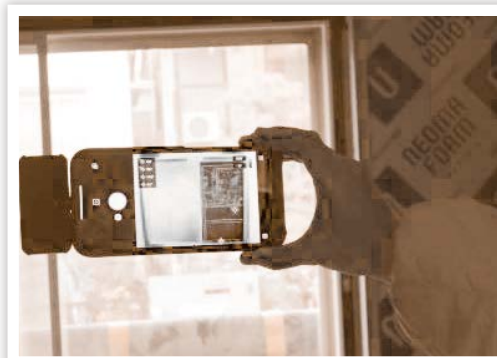
内窓の効果を測定 (右) 内窓なし (左) 内窓あり
