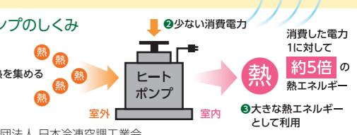
エアコンは、ヒートポンプ技術を利用しています。ヒートポンプは熱を温度の低いところから高いところに移動させることができます。消費した電力1に対して約3倍～5倍の熱エネルギーに変えることができます。電気ストーブと比較すると、とても効率のよい暖房機といえます。
