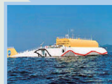
JAMSTECの沖合浮体式波力装置マイティーホール 提供: 独立行政法人海洋研究開発機構
