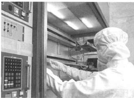
③ 拡散炉の待機温度の変更で消費電力を削減
